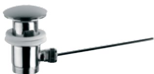
95LG80 € 25,40 Scarico automatico da 1"1/4, tipo lusso lucidato, con tappo grande a copertura totale della piletta. C.P. polished pop-up waste, 1"1/4, luxury type with big plug covering the drain.
