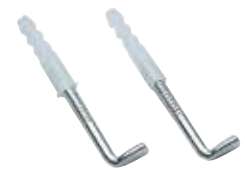
Coppia tiranti con gancio e tassello in acciaio per scaldabagno, lunghezza mm 75, 100. Bag of 2 screws, 75, 100 mm for water-heater, with plastic nuts.
